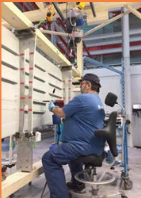
Exemple de poste de ré-accueil en atelier avec cadences contrôlées, possibilité d'assis/debout avec siège ergonomique, système de monte et baisse et système suspensif pour l'outillage manuel.
